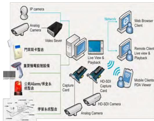
圖 23 監視、門禁、停管及緊急求救系統連動控制
