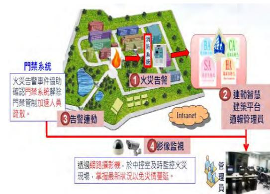
圖 17 消防系統連動控制
