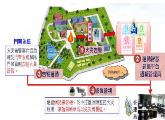
圖 12-21 消防系統連動控制
