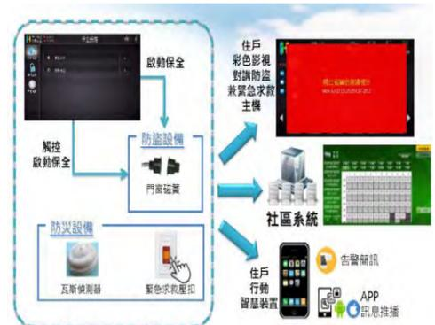
圖 16 自動化系統移報中央監控
