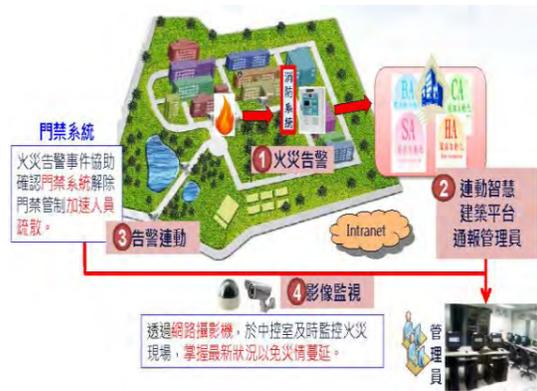
圖 17 消防系統連動控制
